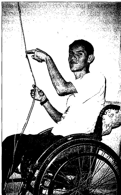
La versión más sencilla del medidor de presión consiste de sólo un globo pegado a un tubo de plástico largo y delgado, que tiene unas marcas o colores que indican las zonas de seguridad, precaución o peligro. El instrumento se puede llevar fácilmente en una bolsa.
