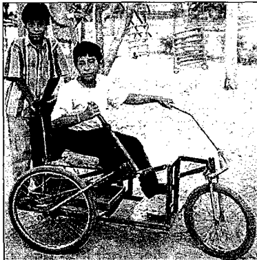
El volante del triciclo está hecho con una horquilla de tubo metálico. La rueda delantera es una llanta de bicicleta de 24 pulgadas.
